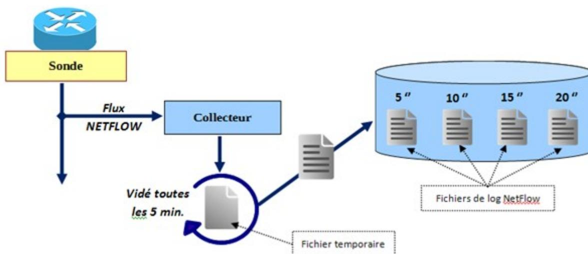
Les flux NetFlow sont générés par la sonde via des règles du parefeu Netfilter (cible « -j Netflow »). Ces flux sont envoyés sur 127.0.0.1:2055. Ils sont récupérés par le collecteur nfcapd qui génère un fichier toutes les 5' dans le répertoire « `/var/log/nfsen/profile_data/live/alcasar_netflow/date_du_jour/` ».
